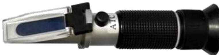
Un campione di alcune gocce di elettrolita è racchiuso tra un prisma di misurazione e una piccola piastra di copertura. Le onde luminose (raggi incidenti) che colpiscono il campione di elettrolita vengono rifratte attraverso di esso sul reticolo di vetro oppure sono riflesse completamente all'interno.
