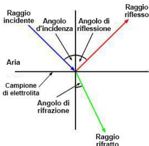
La riflessione interna totale è il ritorno delle onde luminose (raggi incidenti) dopo che hanno colpito la superficie dell'elettrolita racchiuso tra il prisma di misurazione e la piastra di copertura.
