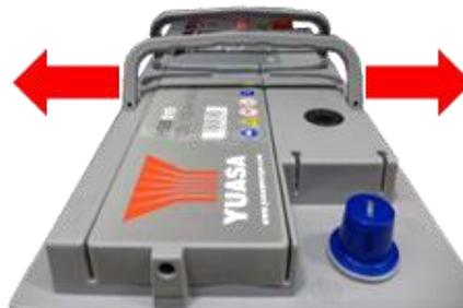
Wenn sich der Griff gelöst hat, kann er das Gewicht der Batterie nicht mehr tragen, sodass eine Gefahr für jede Person besteht, die einen Hebeversuch unternimmt.
